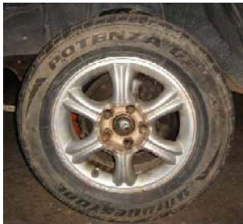
รูปที่ 1 ล้อยางลมที่นำมาวิ่งฝาคะปุเรือใบเพื่อทดสอบตะปุเรือใบ
