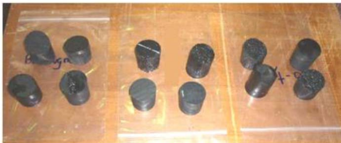
รูปที่ 2.3 ชิ้นทดสอบหลังการตัดเจาะ
