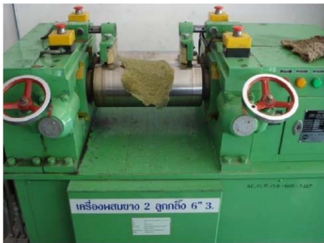
รูปที่ 3.1 แสดงเครื่องผสมยางแบบสองลูกกลิ้ง
