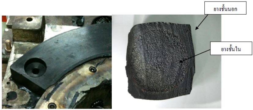
รูปที่ 3.17 (a) แสดงชิ้นงานหลังจากการอัดขึ้นรูป (b) แสดงภาพตัด Section ของชิ้นงานหลังจากการอัดขึ้นรูป
