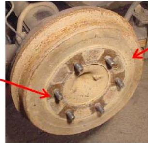
รูปที่ 4 แสดงสกรูยึดคอกล้อของล้อหลังรถกระบะ
