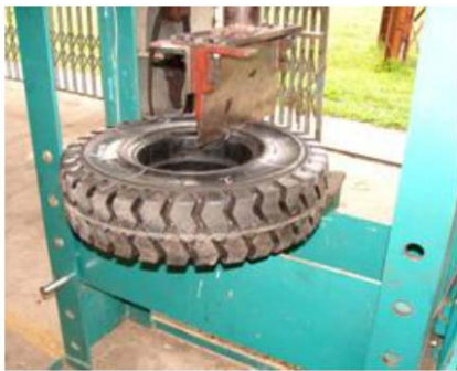
รูปที่ 2.1 บริเวณส่วนของล้อยางสำหรับตัดแบ่งเพื่อทำชิ้นงานทดสอบ
