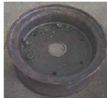
รูปที่ 2 กระทะล้อรถฟอร์คลิฟท์ที่ใช้ในการทดสอบ
