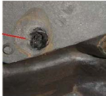
รูปที่ 6 แสดงแผลการเจาะของตะปูเรือใบเจาะบนล้ออย่างตัน
