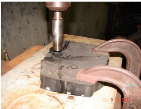
รูปที่ 2.2 การเจาะยางให้ได้ทรงกระบอก
