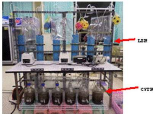
รูป ระบบหมักแบบแห้ง LBR เชื่อมต่อระบบ CSTR
