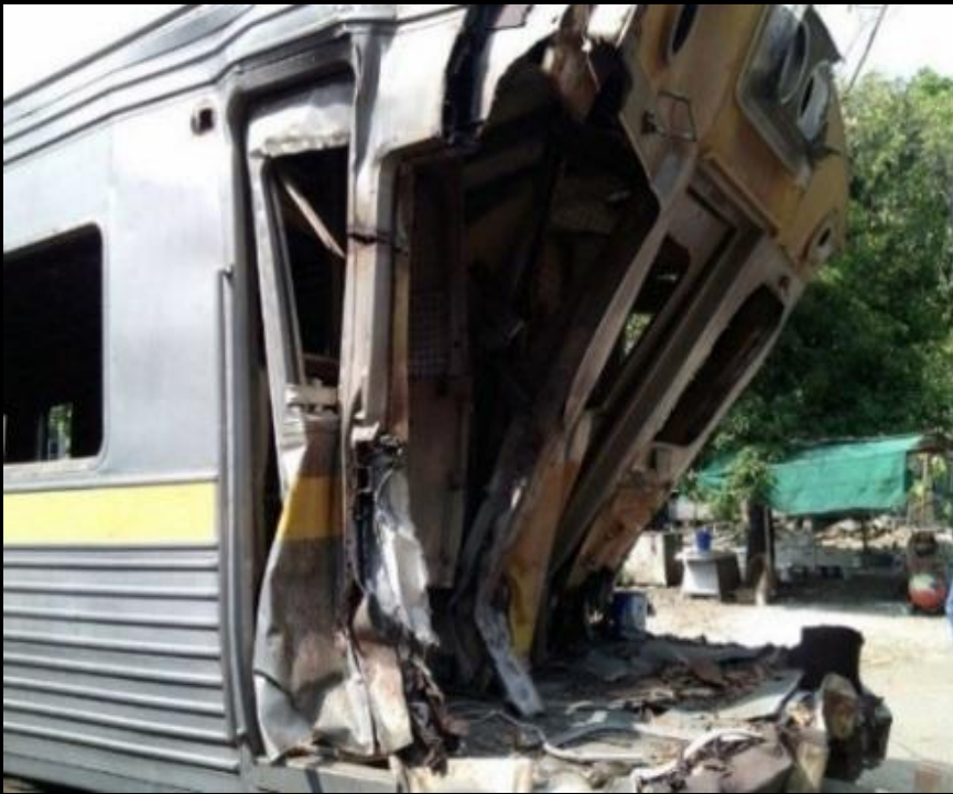
รูปที่ 1 แสดงความเสียหายซึ่งต้องมีการ เชื่อมซ่อม
